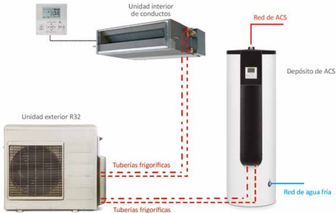
Gráfico 4-25. Caso tipo 2. Piso en bloque. Opción 100% frigorífica. Esquema de principio
